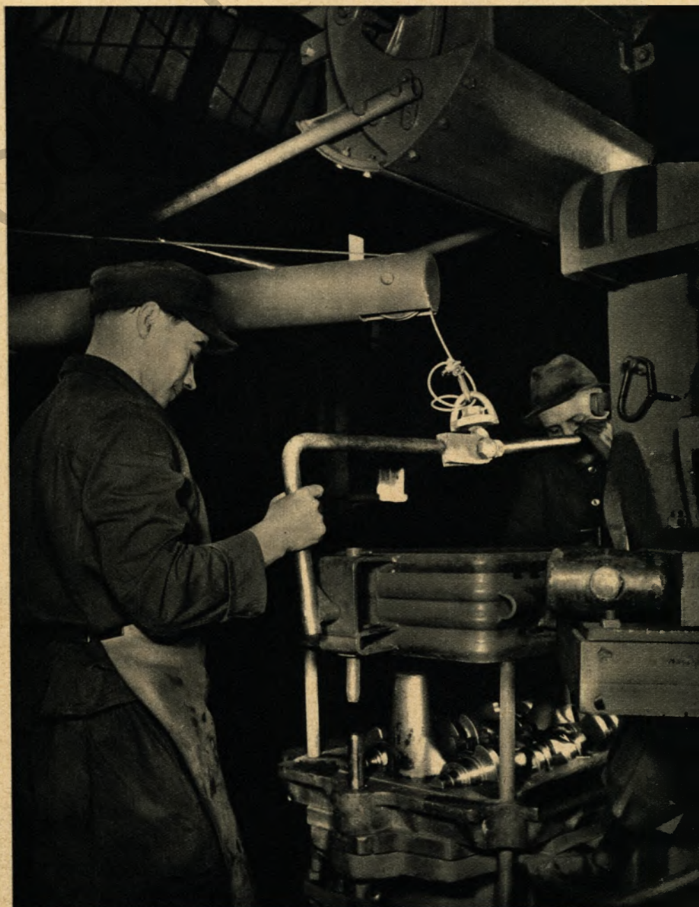
Im Sphärogußverfahren werden im Werk Werdohl Kurbelwellen gegossen Im Vordergrund stellt Horst Weber die Gießform her
