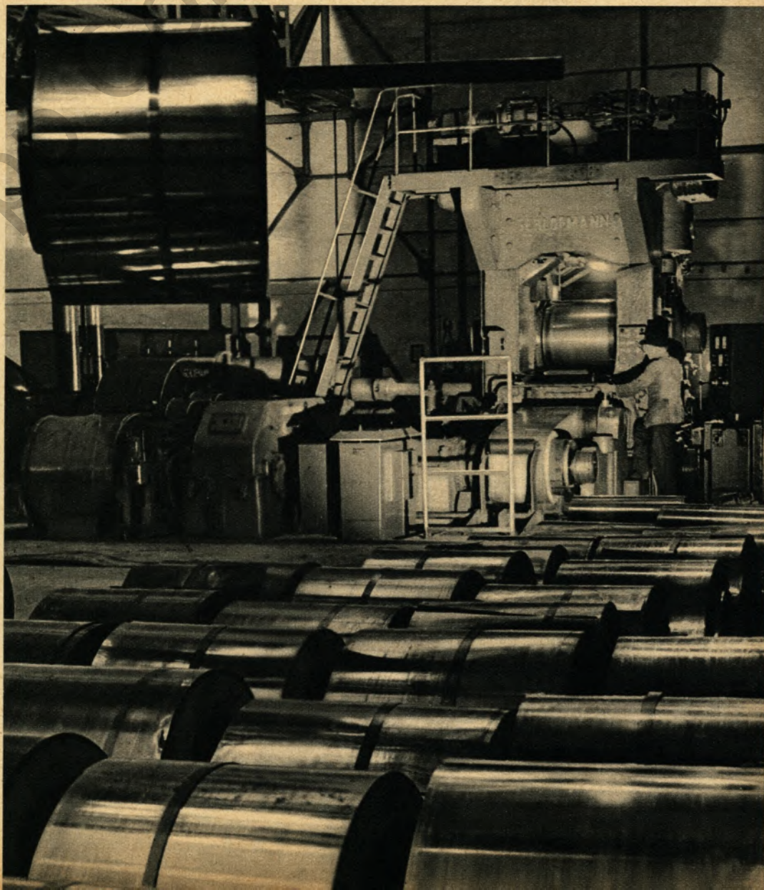
Eins der modernen Kaltwalzgerüste im Werk Nahmer, das zur Hoesch Walzwerke AG gehört
