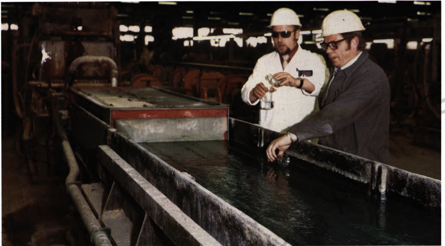
Chemielaborant Franz-Joseph Wieting und Vorarbeiter Karl-Heinz Langkamp bei der Kontrolle des Verkupferungsbades im Kontizug.
