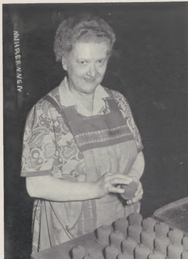
◁ Anna Schmale ist Kernprüferin in der Kern- macherei Papenberg und kon- trolliert die Kerne nach dem Trocknen auf Kerngüte und Maßhaltigkeit
