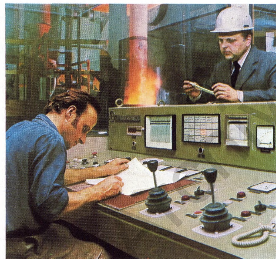
Blick in die Kokille auf die wallende Schlackenoberfläche, an der die hereinragende Elektrode schmilzt (links). Bild unten: Schichtführer Helmut Baar (links) und ESU-Chef Dr. Lutz Rohde im Steuerstand der Anlage. Von hier aus werden die Amperezahl für den Abschmelzprozeß und unter anderem auch die Vorschubgeschwindigkeiten für Elektrode und Kokille gewählt.
