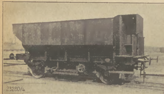
Bild 11: Selbstentlader-Bodenentleerer älterer Bauart, zwischen den Schienen entleerend
