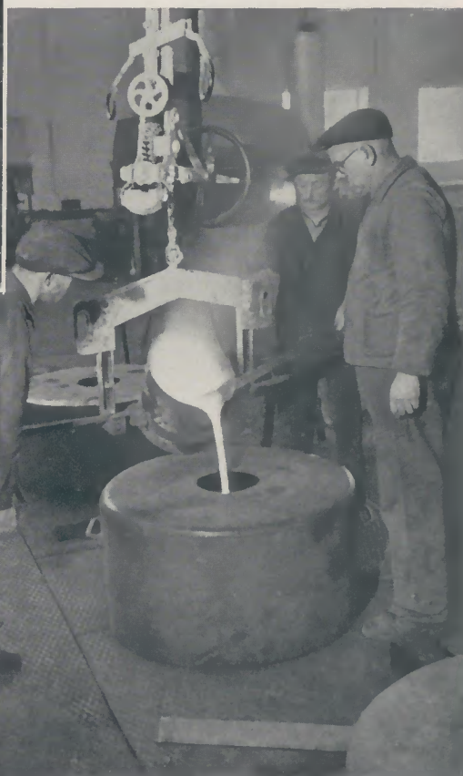
Bild 8: Vertikal-Schleudergußanlage zum Schleudern der Schneckenräder
