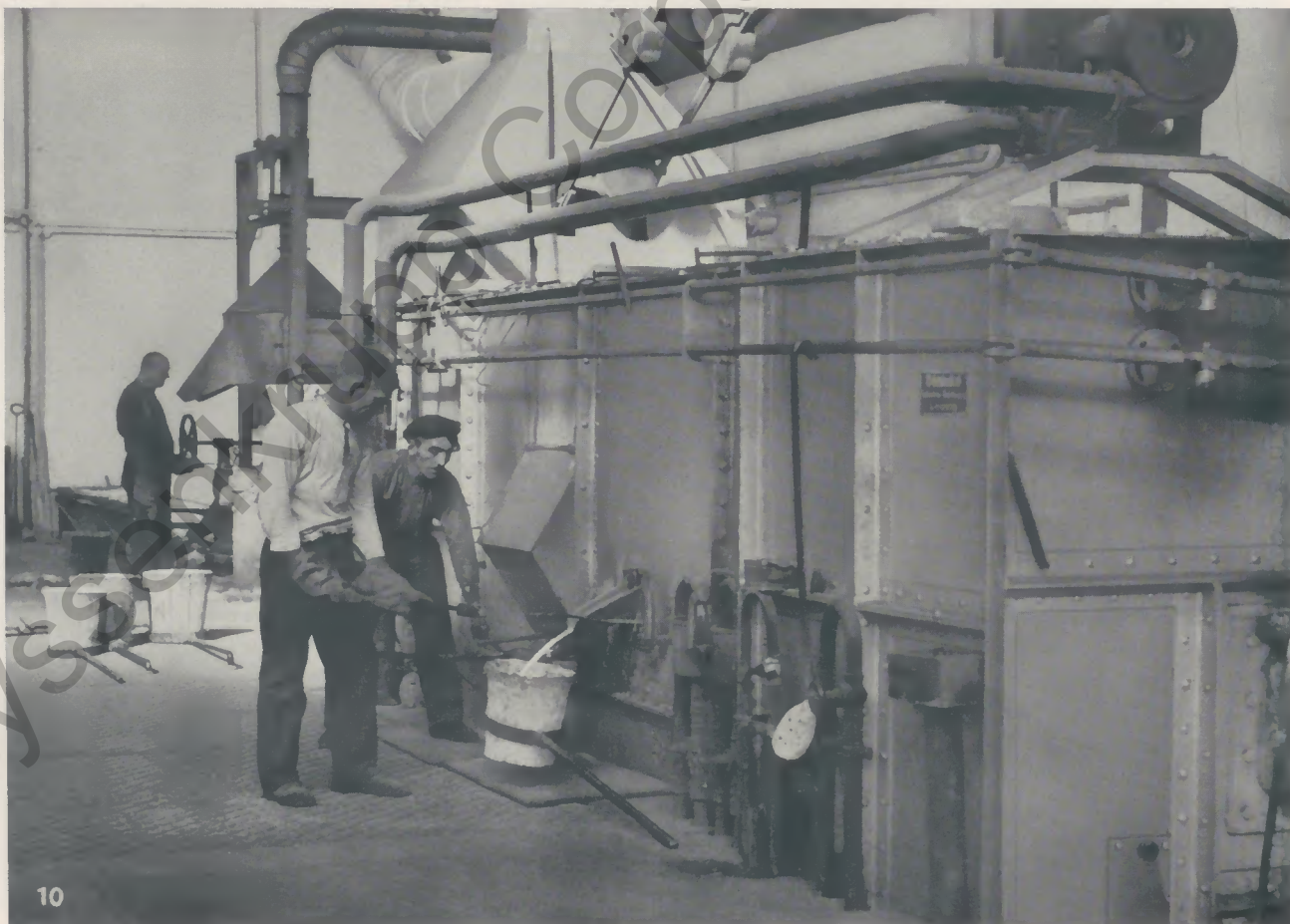
Bild 10: Halbgasflamofen mit mehrstufiger Verbrennung für Siluminlegierungen
