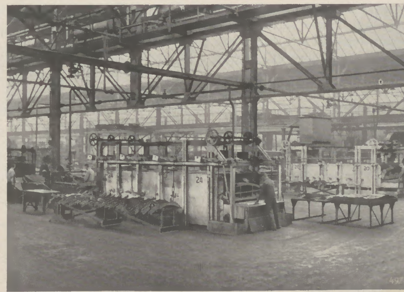
Abb. 8: Härteofen. Der Arbeiter rechts legt Blätter ein. Links kommen Blätter heraus und werden gehärtet
