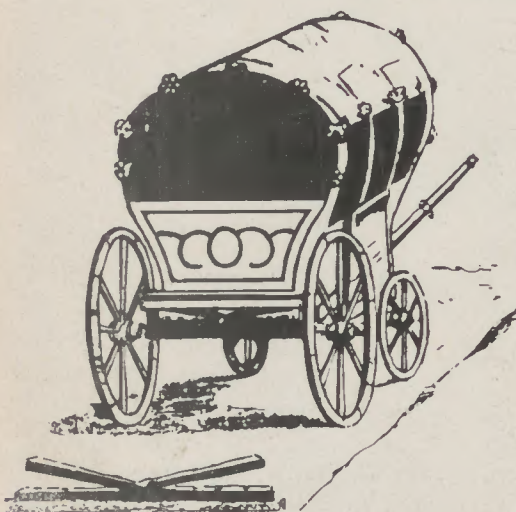
Abb. 3: Reiwagen, auf eisernen Federn gelagert, um 1595. Vorn die Federn noch einmal in vergrößertem Maßstab
