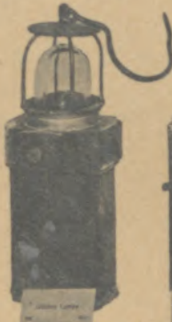
Abb. 10: Älteste elektrische Grubenlampe mit Bleiplatten-Akkumulator
