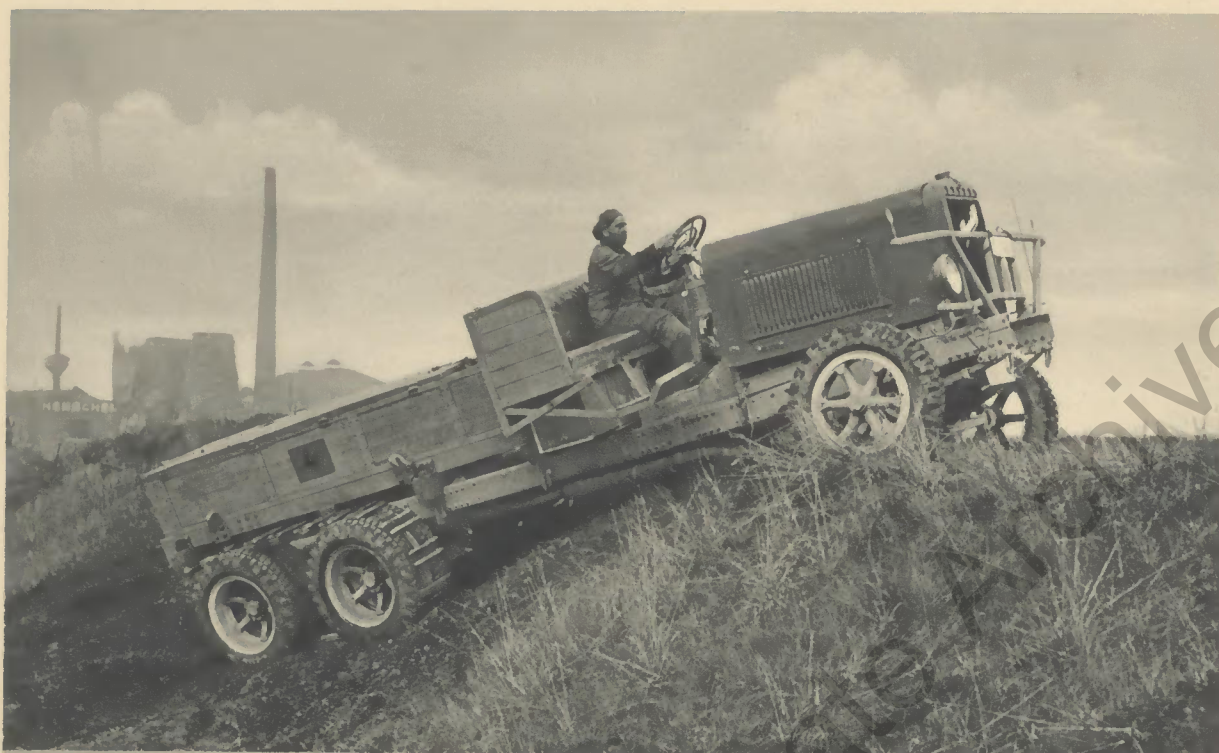
Bild 1. Dreiachs-Geländewagen mit Greiferketten auf den Hinterrädern
