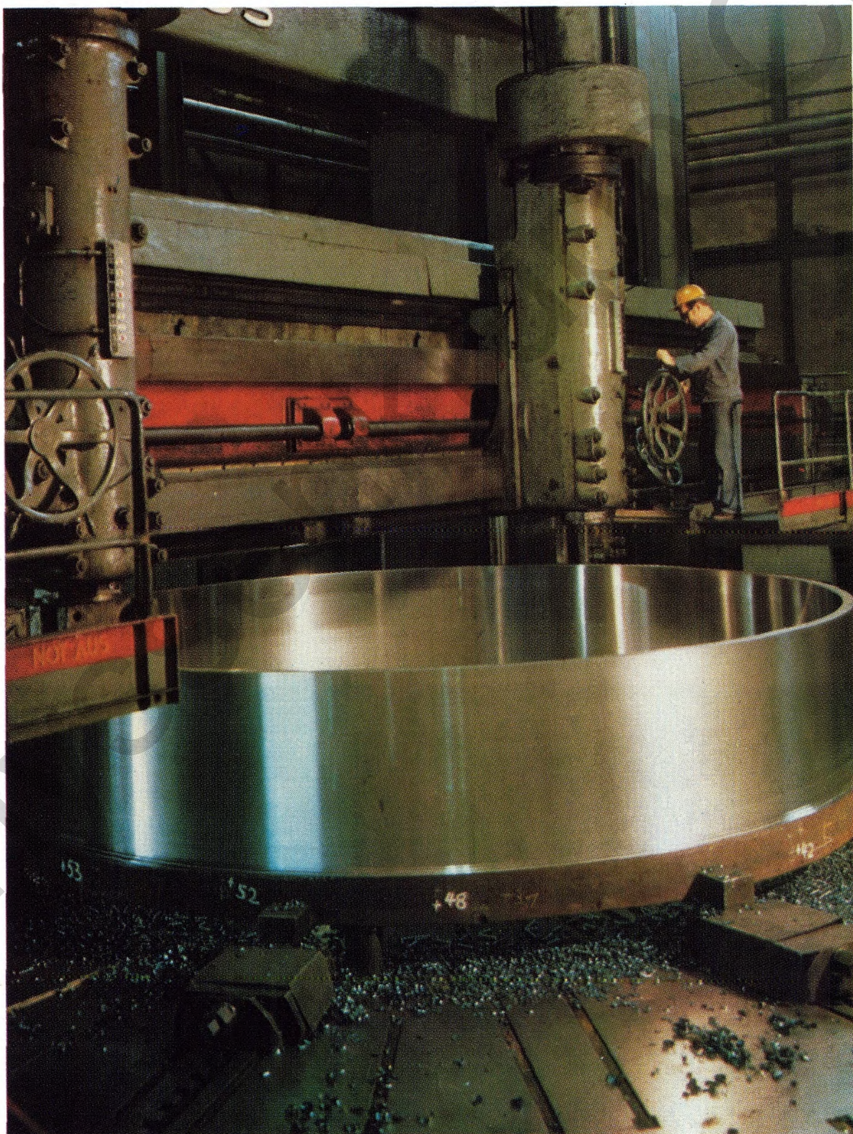
Ein geschmiedeter Ring wird auf einer der größten Karussell-Drehmaschinen der Welt bearbeitet
