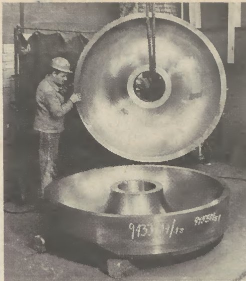
18. Die fertig bearbeiteten Innenoberflächen der beiden Halbschalen für die Pumpenkrümmer vor dem Plattieren.
