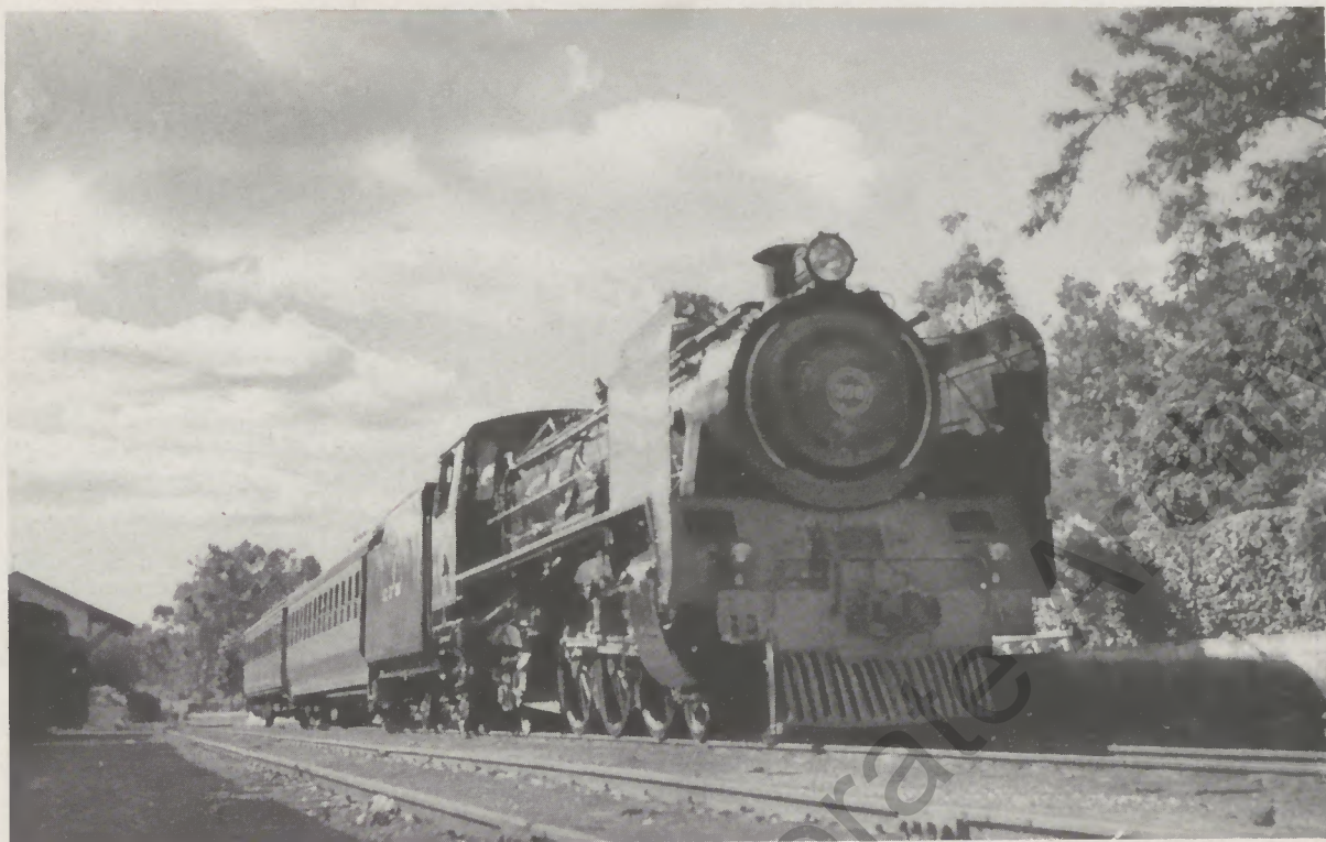
Abb. 18. 2'C1'-Heißdampf-Lokomotive mit Personenzug in Vila-Luiza
