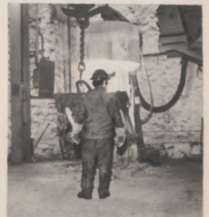
▼ „Impft“ man die Gußeisenschmelze mit Magnesium, fällt der Graphit in Kugelform an – Giovanni Roccotelli an der „Impf-Station“
