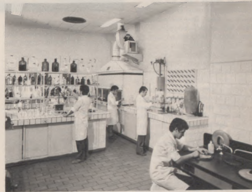
▲ Das eingehende Rohmaterial wird vor der Verarbeitung im Labor chemisch und metallographisch analysiert und kontrolliert
