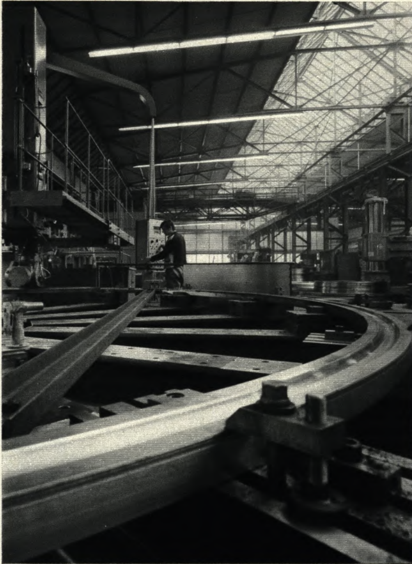
◀ Auf dieser neuen Karusselldrehmaschine im Werk Lippstadt der Rothe Erde-Schmiedag AG werden Kugel- und Rollenlager mit einem Durchmesser bis zu acht Meter und einem Gewicht bis zu vierzig Tonnen gedreht und geschliffen
