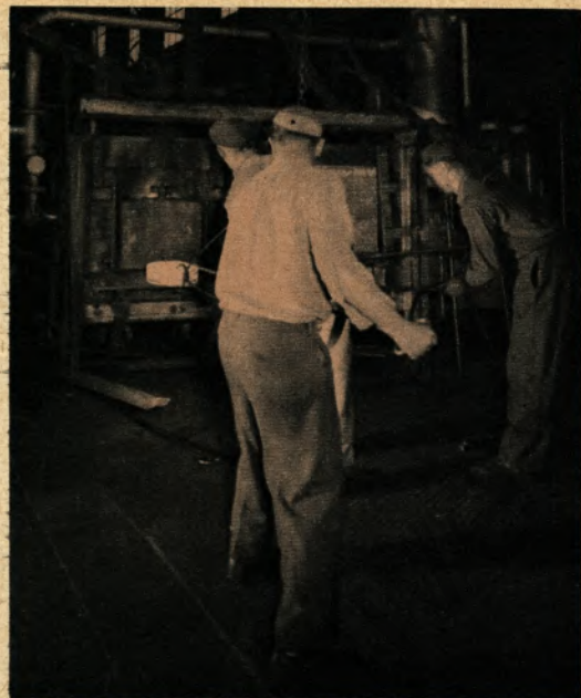
▲ Der vorgeschmiedete schwere Rohling verläßt den Schmiedeofen und wird dem großen Gesenkhämmer der Schwinn AG zugeführt. Von links nach rechts: Heinrich Uhl, Otto Hübscher und Karl Gatzemeier
