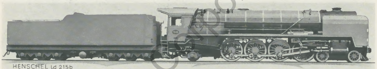
2 D 1 HEISSDAMPF-2-ZYLINDER-LOKOMOTIVE KLASSE 23 DER SUDAFRIKANISCHEN STAATSBAHNEN
