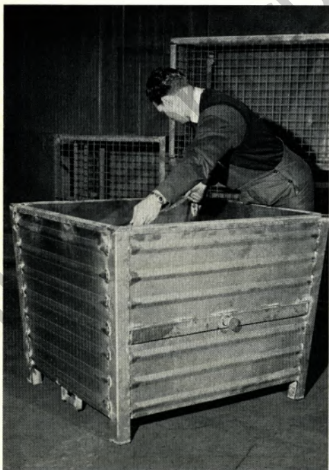
Ein Kippbehälter (DBP) aus der Stahlleichtbau-Fertigung des Eisenwerkes Steele in der Werksprüfung
