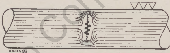
Wie oben: Der Anriß ist bedeutend größer geworden Vor dem Endbruch
