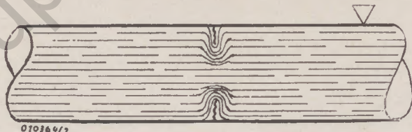
Drehriefen an der Oberfläche und dadurch hervorgerufen örtliche Spannungsanhäufung bewirken das Entstehen eines Dauerbruches
