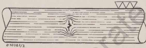
Durch Schlackeneinschlüsse im Kern Anhäufung der Spannungen am Uebergang, Einschlüsse, gutes Material und Entstehung eines Anrisses
