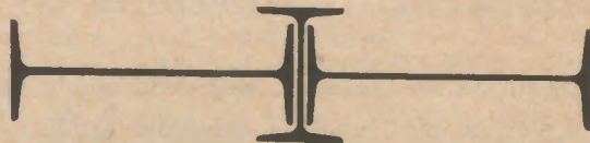
Erste Ausbildungen von Stahlpundwänden aus normalen Profilstählen
