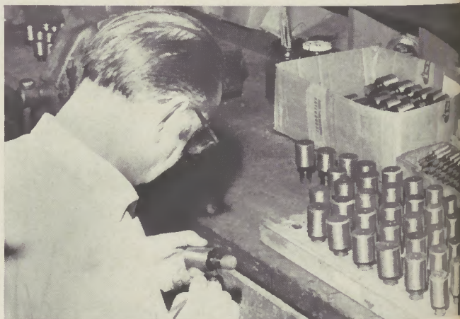
Stellen, die nicht verchromt werden sollen, isoliert man mit einer säurefesten Masse.
