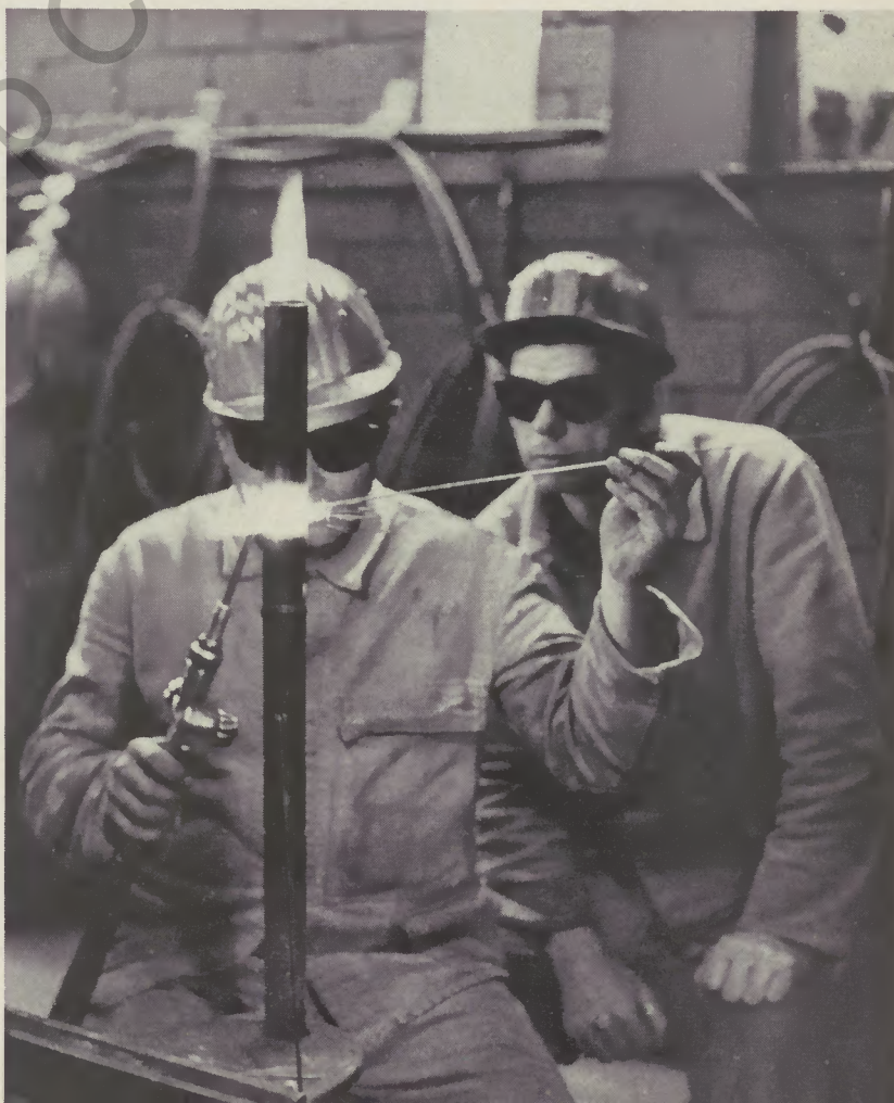
Die autogene Kehlnahtschweißerei an Dünnblechen erfordert viel Übung.
