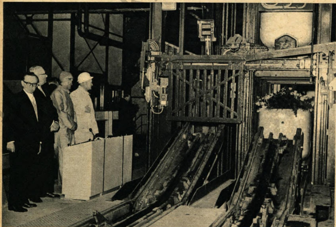
► Dieses Bild ist wie ein Symbol der modernen Technik: verglichen mit der Maschine, ist der Mensch winzig klein, und doch steuert er sie mit dem Druck eines Fingers. Unser Bild zeigt die Fördermaschine des Hansenschachtes, deren Motor die Treibscheibe bewegt, über der die Förderseile liegen
