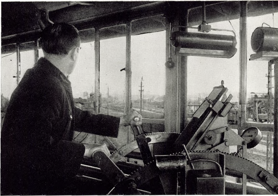
Der Steuerstand für die Gleisbremsen auf dem Rangierbahnhof Oberhausen—Osterfeld-Süd der Bundesbahn
