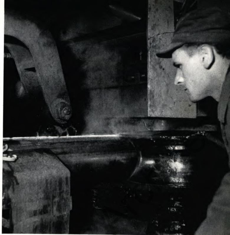
Steuermann Ferdinand Zimmermann beobachtet an der Induktions-schweißanlage 2 1/2 bis 6 Zoll eine frische Schweißnaht
