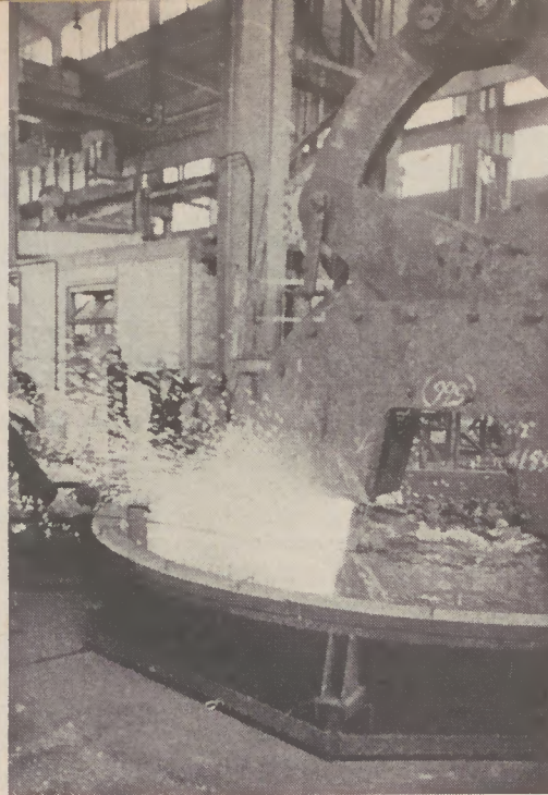
Die Zange muß den Riesen gut greifen können. Vorsichtshalber werden links und rechts Vertiefungen geschweißt.
