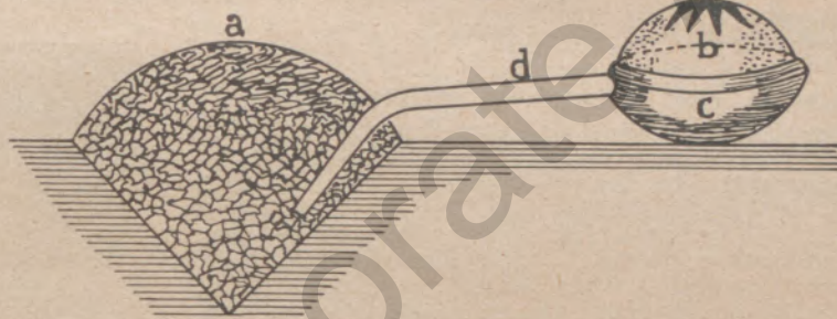
Abb. 2: Rennherdbetrieb in Kordofan (Afrika), nach Kufeger. Der Durchmesser der Grube mißt 12 bis 14 Zoll. Das Gebläse besteht aus einer mit Haut bespannten Tonschüssel, in deren Loch der Arbeiter seine Finger steckt. Aus Bedf. Geschichte des Eisens
