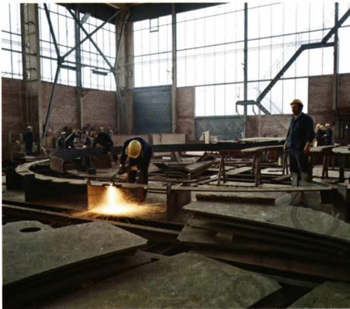
Fertigung von Vakuumringen. Bild unten: Schlagschotte in der Fertigung.
