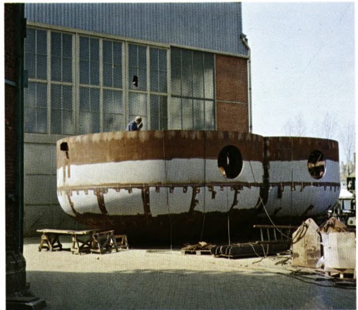
Tankalottenfertigung für einen 12000-Kubikmeter-Gastanker. Bild unten: Zylindrischer Schuß mit Bodentank 1.
