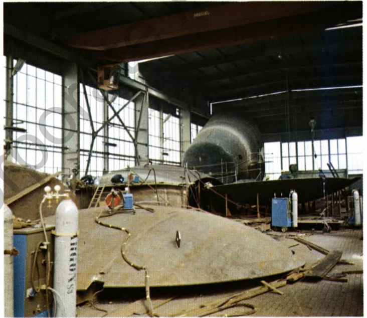
Tankalottenfertigung für einen 12000-Kubikmeter-Gastanker. Bild unten: Zylindrischer Schuß mit Bodentank 1.
