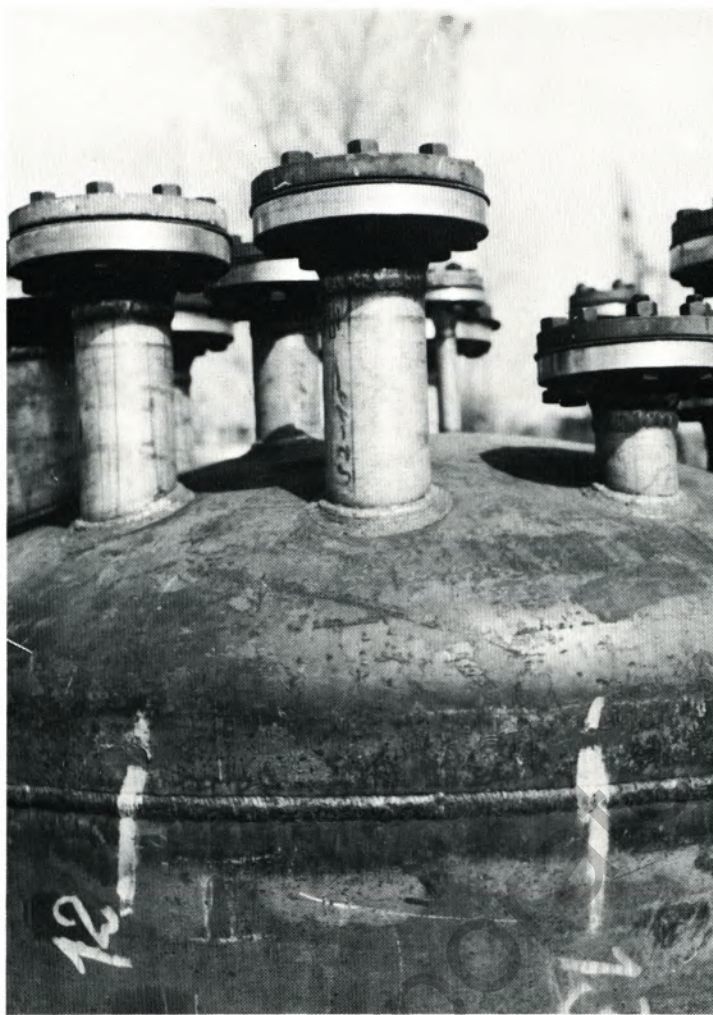
Armaturendom mit Blindflanschen fertig zur Druckprobe.
