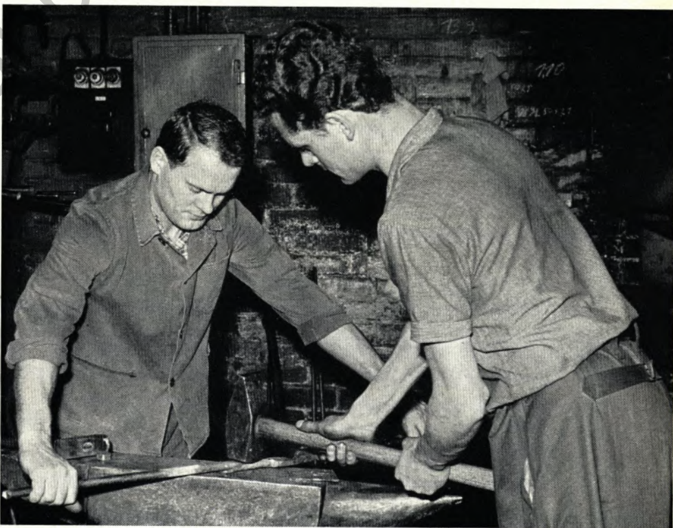
Eine schwierige Schmiedearbeit: Das Feuerschweißen. Im Schmiedefeuer zu heller Weißglut gebracht, werden die beiden Enden mit schnellen Hammerschlägen verschweißt.
