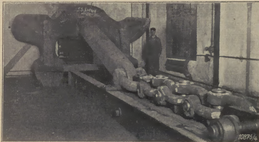
Zugprobe mit der Ankerprüfmaschine Zugkraft: 120 600 Kilogramm
