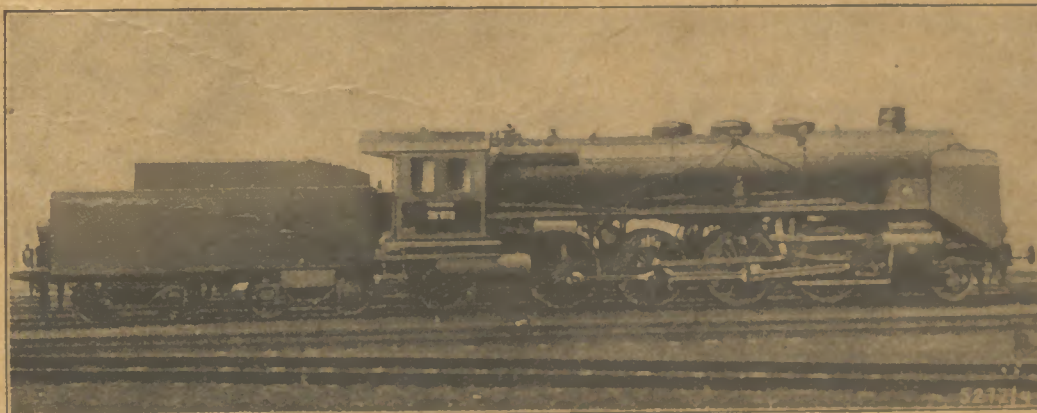
Dreizylinder-Heißdampf-Personenzug-Lokomotive der Firma Fried. Krupp A.-G. 14 atü, Dienstgewicht 111 t, Leergewicht 100 t, Geschw. bis 110 km i. d. Std., Leistung 1000 PS
