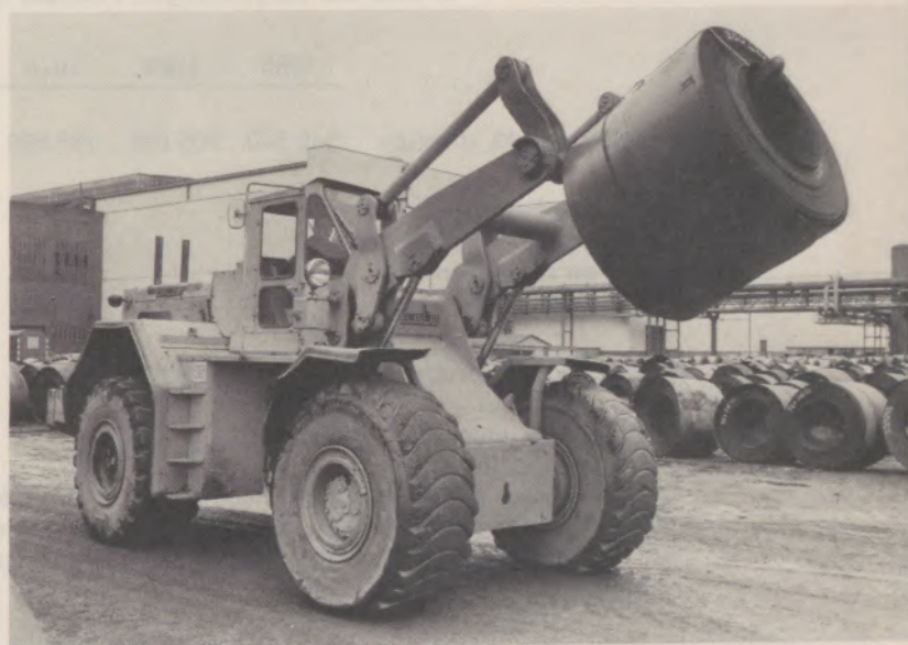
Ein mit einem Dorn ausgerüsteter Radlader transportiert und verlädt außerhalb der Hallen des Breitband- und Kaltwalzwerkes Coils bis zu 15 t Gewicht
