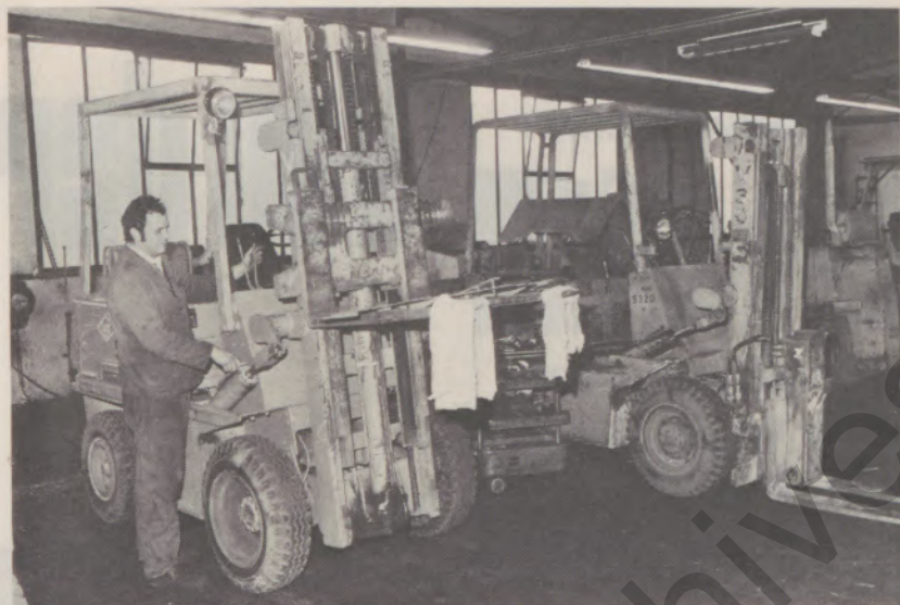
Großreparaturen an Gabelstaplern führt die Reparaturwerkstatt des Werkes Union aus. Kurt Henning bemüht sich um einen O & K-Stapler, dessen Getriebe defekt ist
