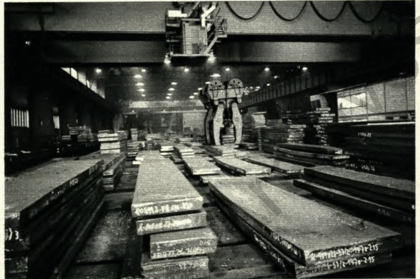
◀ Die Zangenschenkel greifen nicht unter die Last, sondern pressen sich von den Seiten gleichmäßig gegen Brammen
