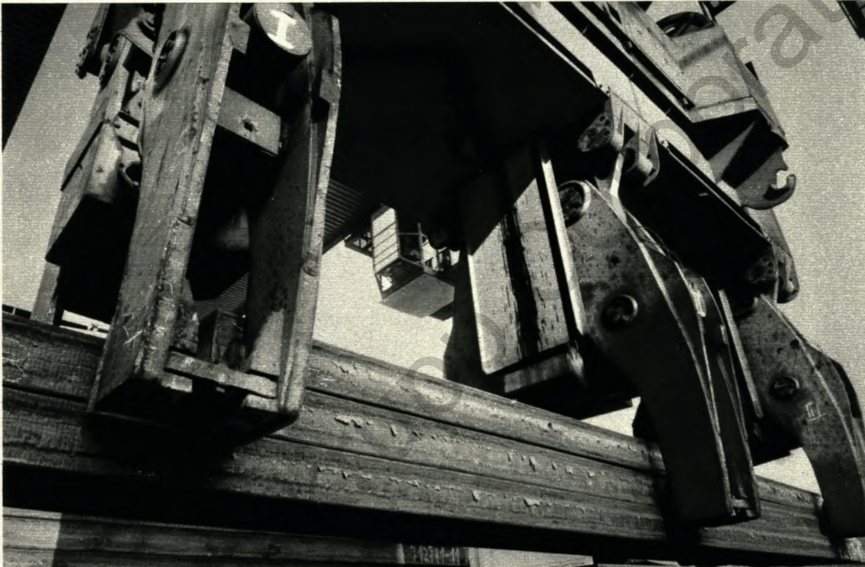
400 Tonnen wiegt der Brammentransportkran, der in der Breitbandstraße der Westfalenhütte arbeitet. Seine Hubkraft beträgt 125 Tonnen ohne das Gewicht des Zangengehänges von 50 Tonnen
