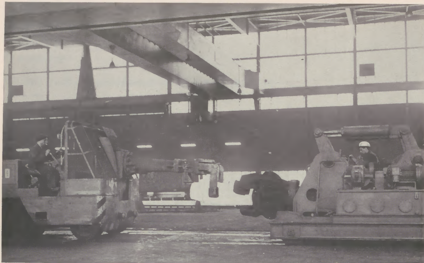
Die Auto-Zangenchargiermaschine übergibt den warmen Block dem Schmiedemanipulator.
