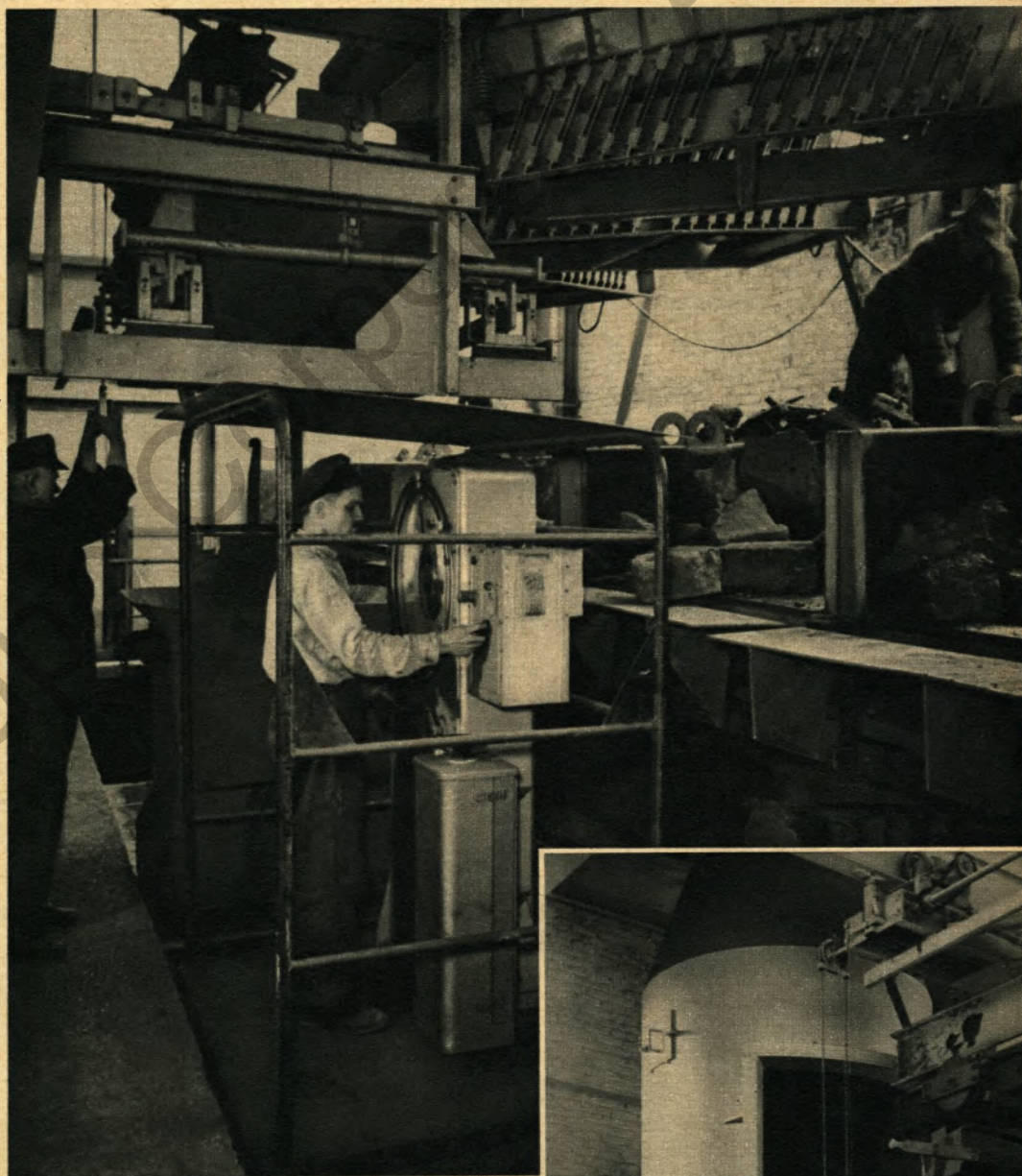
▲ In der neuen Beschickungsanlage wird der Einsatz für die Kupolöfen zusammengestellt. Auf dem Waggon befinden sich verschiedene Roheisensorten und Gußbruch, deren Anteil Horst Krause genau auswiegt
