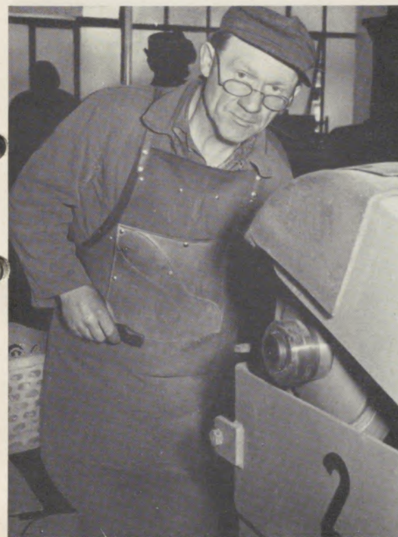
Wilhelm Martin, Fittingsschleifer in der Schleiferei Papenberg, säubert die Rohfittings auf dem Schleifbock von Angüssen und Graten.
