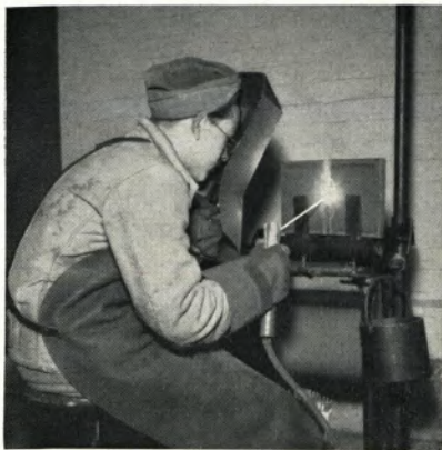
Auch das Gasschweißen, das sog. Autogenschweißen, gehört zum Ausbildungsprogramm
