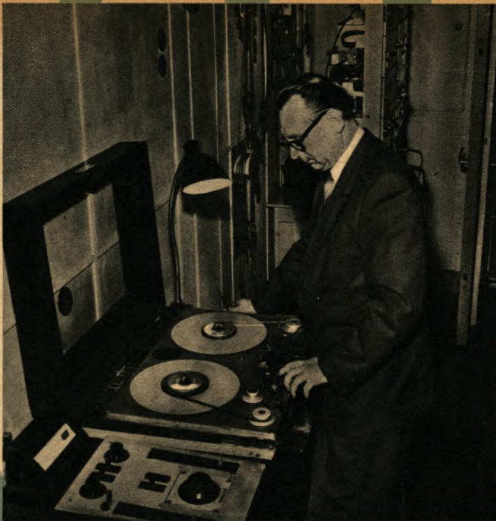
Bild oben Gustel Hellemann am Bandgerät! Mit einer Schere schneidet er komplizierte Nebensätze und störende oder überflüssige Worte und Geräusche aus der Aufnahme
