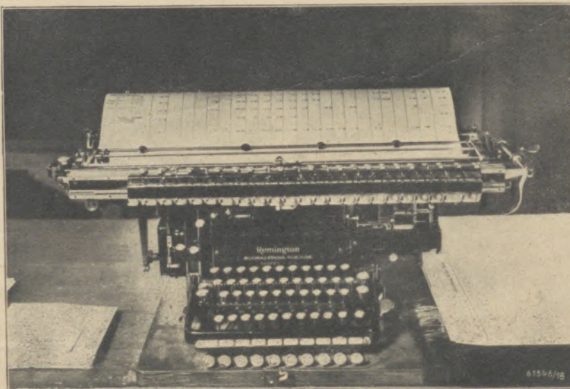
Buchungsmaschine, auf der oberen Leiste befinden sich die 23 Zählwerke
