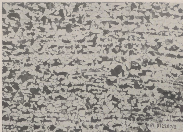
Stahl mit 0,30 v. H. C Ferrit und Perlit
