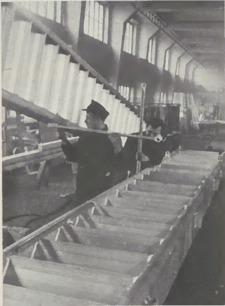
Nicht für Landratten: Aus Aluminiumblech geschweißte Fallreeps für den Schiffbau
