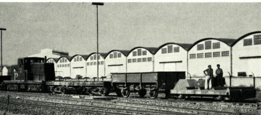
Lok mit Flachwagen, Match-Car und Link-Car. Match-Car: Verbindungswagen zwischen Wagen mit Schraubkupplung und automatischer Kupplung. Link-Car: Verbindungswagen zwischen Blocktransportwagen und Wagen mit automatischer Kupplung.
