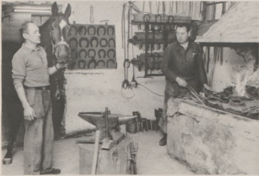
▲ In der alten Schmiede: An der Wand die selbstgeschmiedeten orthopädischen Hufeisen
