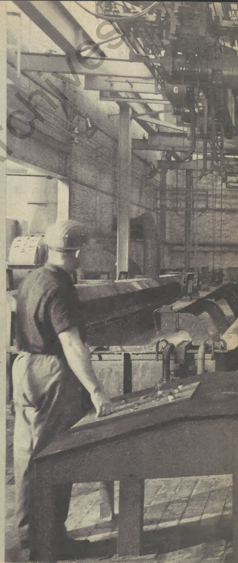
In der automatischen Beize werden die Dämpfe sofort seitlich abgesaugt und der ganze Arbeitsvorgang von einem Steuerpult aus überwacht.
