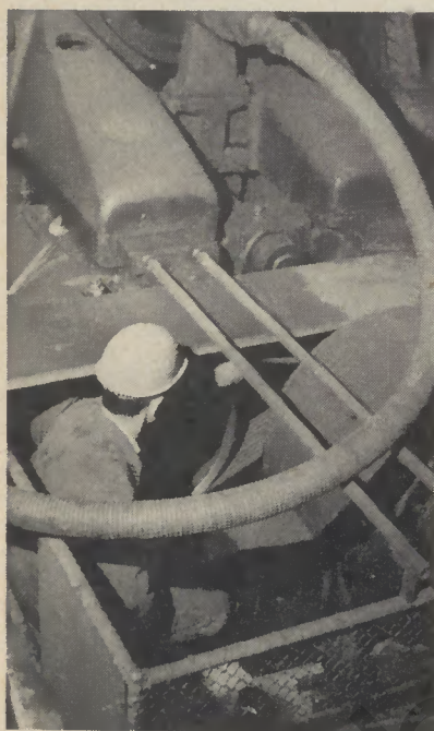
Kontrolle der Keilriemenspannung an der Blockrohrbank.
