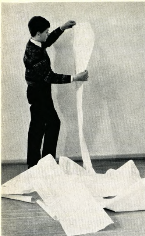
Das Auswertungsblatt von der Lochkartenstelle für den Schrottverkehr eines Monats auf der Niederrheinischen Hütte; Länge 16,40 m. Es weist rund 45 000 Zahlen mit ungefähr 100 000 Ziffern für 137 Verkehrsbeziehungen im Schrottverkehr der Hüttenbahn auf. Die Auswertung in der elektronischen Rechenanlage beansprucht etwa 20 Minuten.
