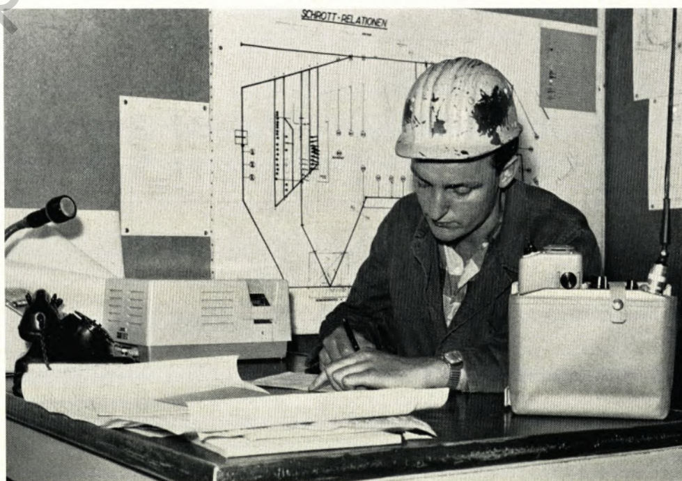
Mikrofon der Wechselsprechanlage, Wählfernsprecher, Empfänger für Fernschreiben von den Gleiswaagen und Rangierfunk am Arbeitsplatz des Disponenten für das Schrott-Transport-Programm der Hüttenbahn
