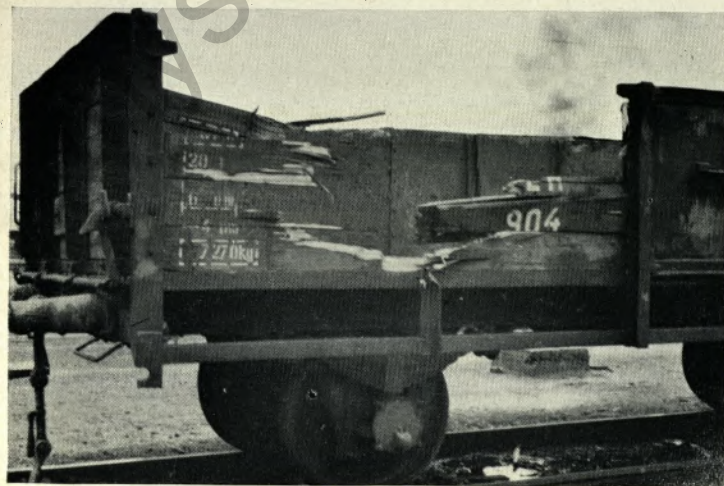
Durch pendelnde Greifer bzw. Magneten vollkommen zerschlagene Seitenwände eines hölzernen und eines eisernen 0-Wagens.
