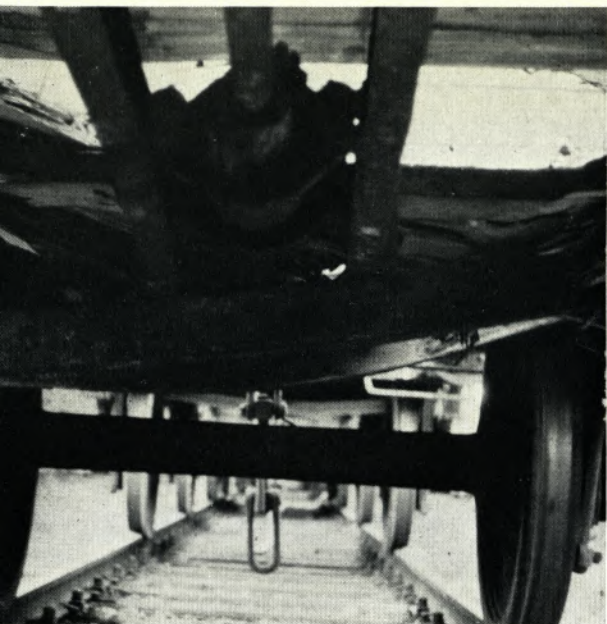
In einem eisernen O-Wagen wurde Warmgut verladen. Durch Wärmespannungen hat sich dadurch der Boden aufgeworfen und wurde anschließend von Greiferzähnen an den Schweißnähten aufgerissen.
