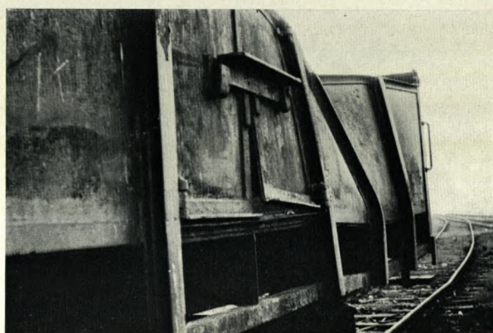
Durch pendelnde Greifer bzw. Magneten vollkommen zerschlagene Seitenwände eines hölzernen und eines eisernen 0-Wagens.
