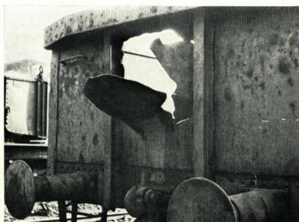
Beim Verziehen von Oo-Wagen mittels Greifer herausgeschlagene 10 mm starke Kopfswand.
