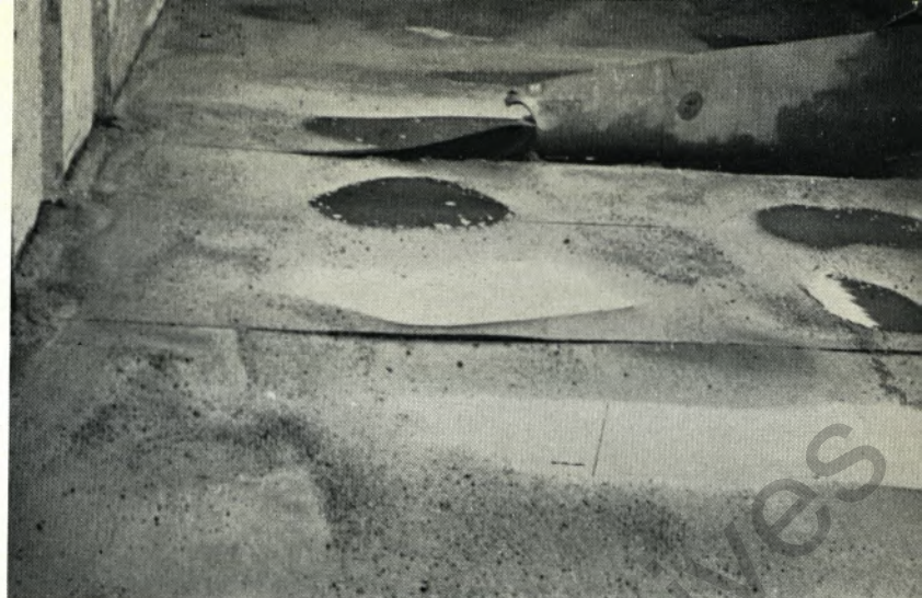
In einem eisernen O-Wagen wurde Warmgut verladen. Durch Wärmespannungen hat sich dadurch der Boden aufgeworfen und wurde anschließend von Greiferzähnen an den Schweißnähten aufgerissen.
