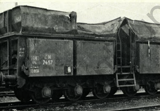
Beim Verziehen von Oo-Wagen mittels Greifer herausgeschlagene 10 mm starke Kopfswand.
