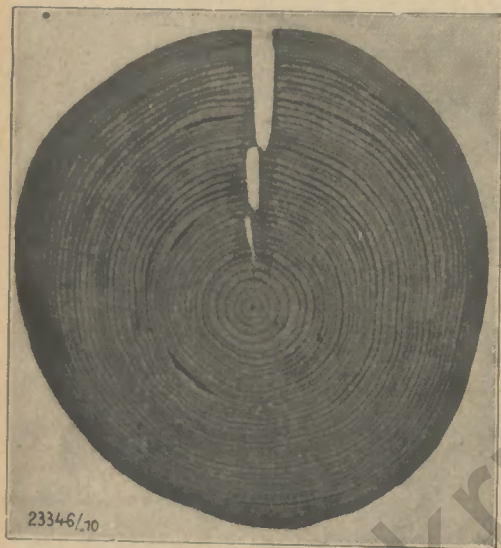
Abb. 1: Querschnitt aus dem Stammholz der Fichte mit Trockenriß und Harzgallen
