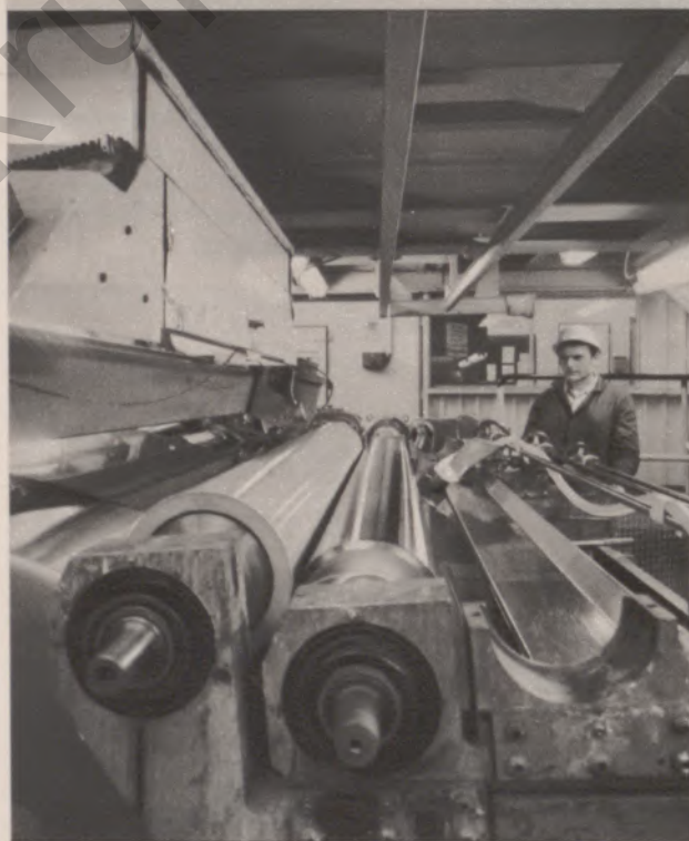
Hier folgt die Beschichtung mit Kunststoff
