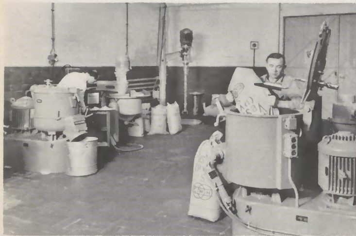
1 Heizmischer FM 150 (Vordergrund rechts), Kühlmischer FM 150 (Vordergrund links), Reibautomat (mitte links), Multifrequenz-Rührwerk (Hintergrund).
