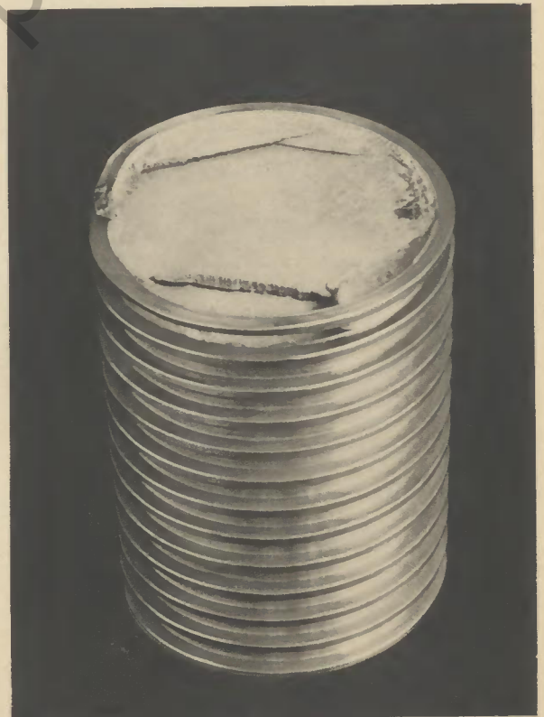
Bild 7: Dauerbruch einer Schraube von 72 mm \varnothing . Man beachte den Anriß im zweiten Gewindegang
