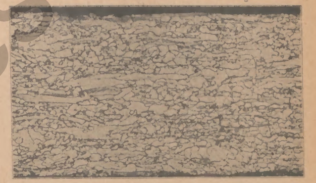
Abb. 18: Hundertfach vergrößerter Querschnitt durch die Blechdicke eines nicht hoch genug geglühten und daher noch zu harten Bandes. Infolge der zu niedrig gewählten Glüh-temperatur sind die durch das Walzen gestreckten und harten Kristalle teilweise erhalten geblieben
