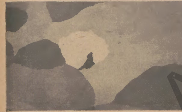
Abb. 15: Ohne Vergrößerung wiedergegebene Eisenkristalle mit einem mittleren Durchmesser von 1—5 Zentimeter (sehr sprödes Eisen)
