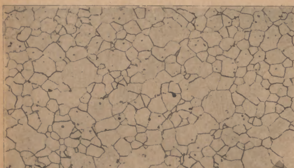
Abb. 13: Hundertfach vergrößerte Eisenkristalle. Sie besitzen in Wirklichkeit einen mittleren Durchmesser von nur 0,03 Millimeter (feinkörniges und daher zähes Eisen)
