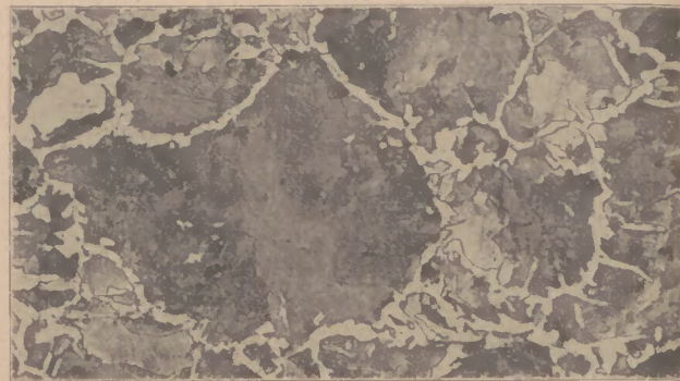
Abb. 24: Hundertfach vergrößertes Gefüge eines überhitzt geschmiedeten und daher grobkörnig und spröde ausgefallenen Werkstückes
