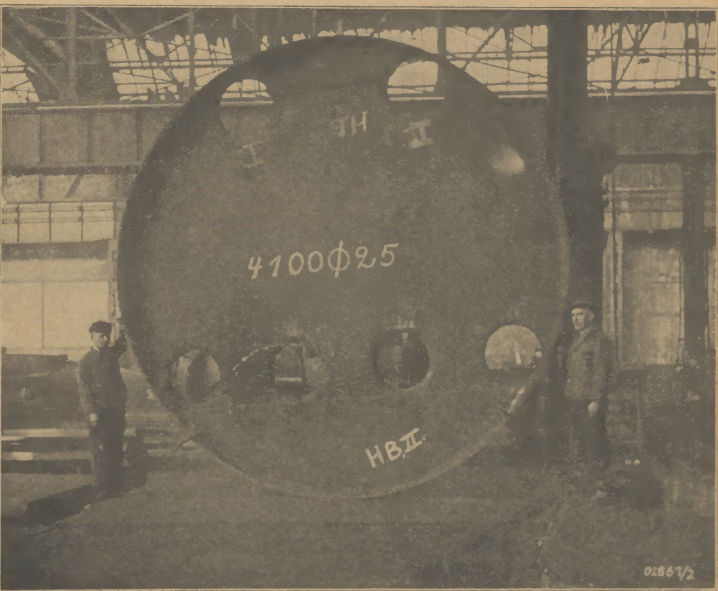
Zweiteiliger Kesselboden, 4100 Millimeter Durchmesser, 25 Millimeter Wandstärke
